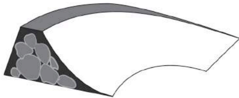
Coupe d'un virage relevé avec construction en pierres (source: bpa, Documentation technique 2.040 – Installations pour VTT)
